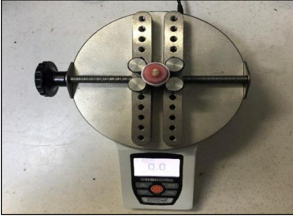
Şekil 2. Dijital tork ölçüm cihazına yerleştirilen test numunesi. Prefabrik dental post setinin (A-Dental, Türkiye) iki farklı çapta olan long 4 (1 mm) ve 6 (1.25 mm) numaralı postları hazırlanan post yuvalarına lentülo ile cam iyonomer siman (Nova Glass-L; IMICRYL, Konya, Türkiye) gönderildikten sonra simana bulanıp yerleştirildi. Daha sonra kuvveti düzgün şekilde uygulamak amacıyla ratchete (Nucleoss, Türkiye) (Şekil 3) uyumlandırılmış erkek post anahtarı yardımıyla sabit kullanıcı ile manuel tork kuvveti uygulandı ve kırık oluşturulan kuvvetler not edildi.
